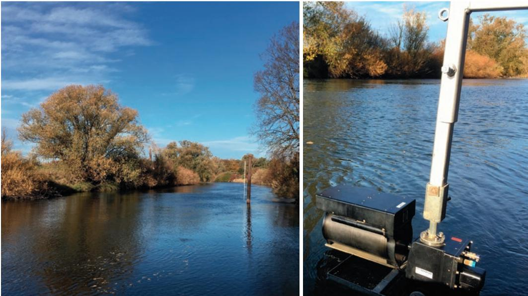
Abb. 64: Standort des Sonars in der Lippe bei Wesel (km 3) (links, Blickrichtung flussabwärts), das DIDSON wurde mit einer speziell dafür angefertigten Halterung an einem alten Pegel befestigt (rechts).
