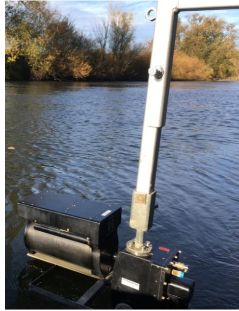
Abb. 47: Standort des Sonars in der Lippe bei Wesel (km 3) (links, Blickrichtung flussabwärts), das DIDSON wurde mit einer speziell dafür angefertigten Halterung an einem alten Pegel befestigt (rechts).
