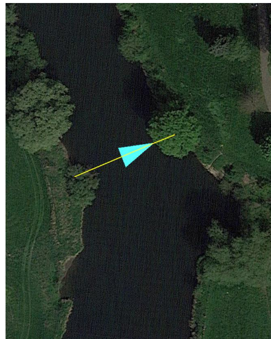
Abb. 48: Standort des DIDSON in der Lippe bei Wesel, Tiefenprofil der Untersuchungsstelle (links) und Ausrichtung des Schallkegels (blaues Dreieck, rechts). Die gelbe Linie stellt die Breite der Lippe an dieser Stelle dar (33 m zum Zeitpunkt der Messung).
