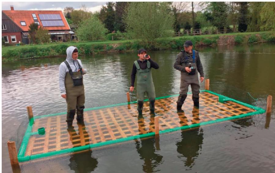
Belastungstest der Eigenbau-Schwimmsel des SFV Coesfeld
