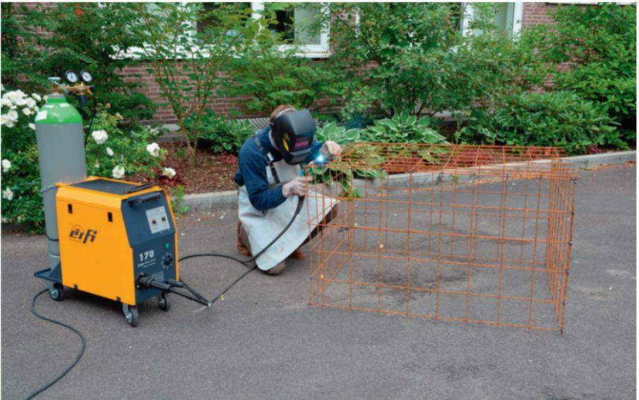
Schutzkäfige lassen sich mit Hilfe eines Schweißgeräts einfach und schnell montieren
